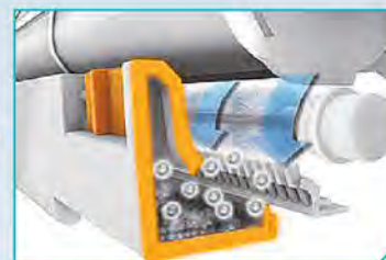
นำฝุ่นที่ทำความสะอาดเก็บสะสมไว้ในกล่องฝุ่น
